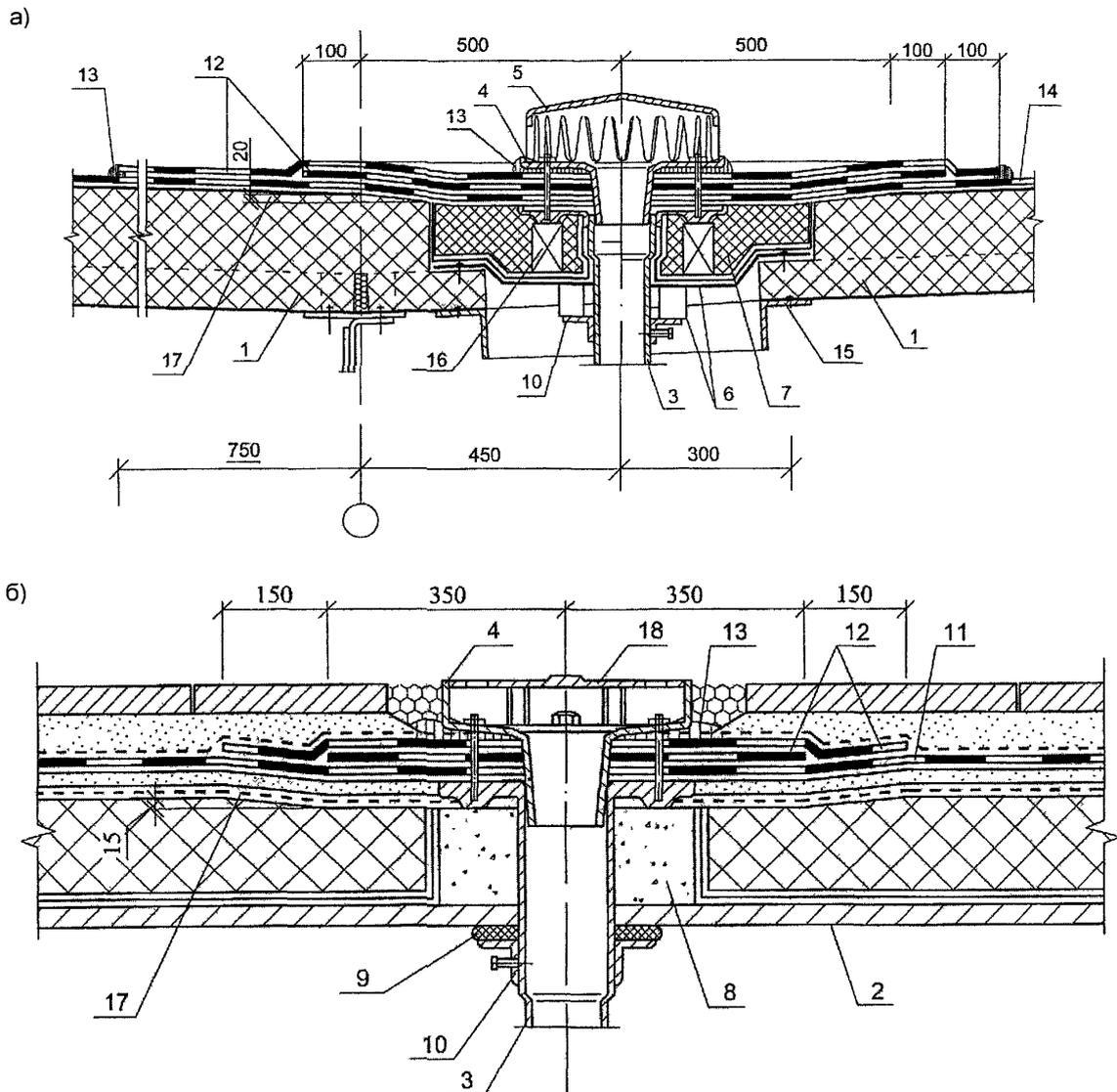
Рис. 1.1. – 1.2. Водоприемная воронка
