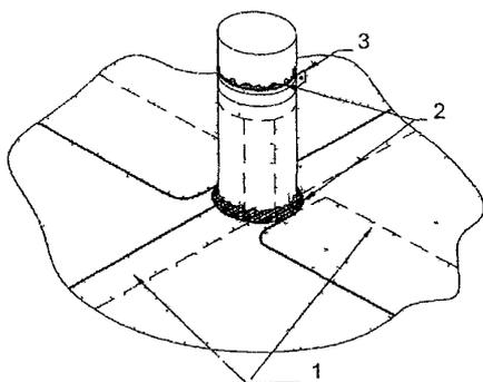
Рис 2 22 Обклейка трубы верхним слоем основного водоизоляционного ковра
