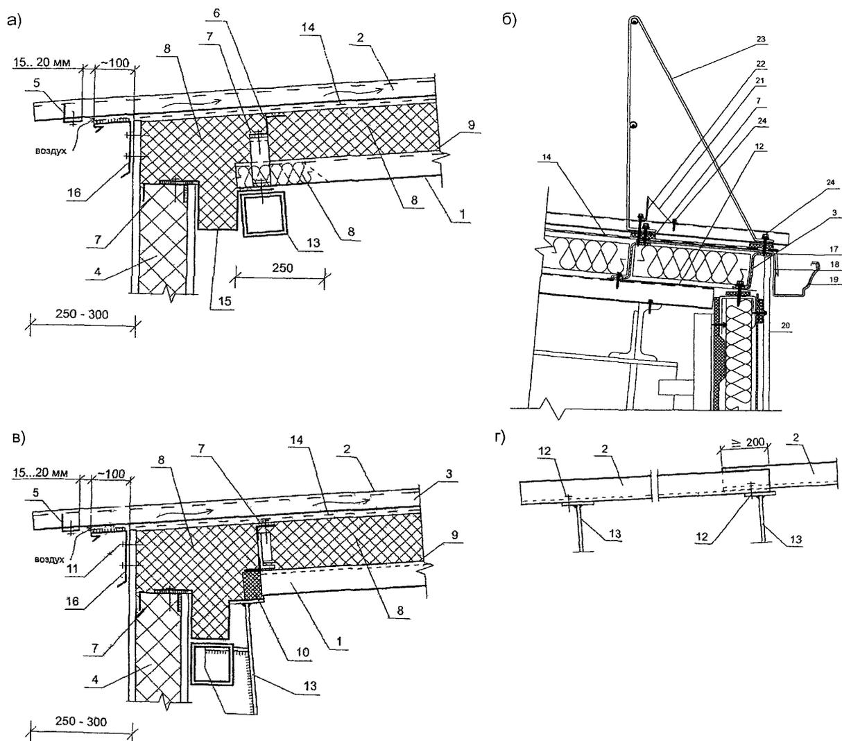
Рис. 1.54. Карниз кровли из металлических профилированных листов
