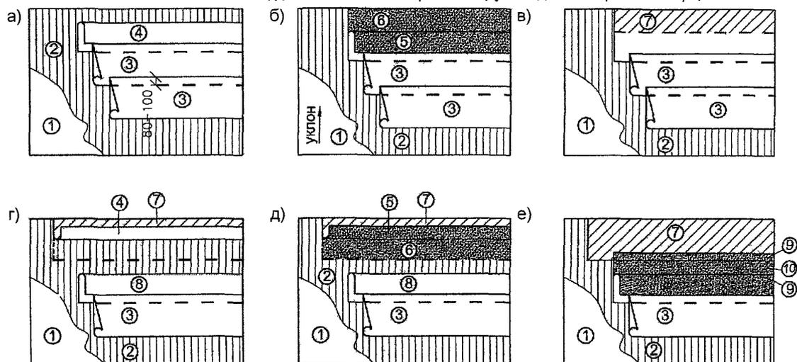
Рис. 2.8. Последовательность наклейки эластомерной пленки
