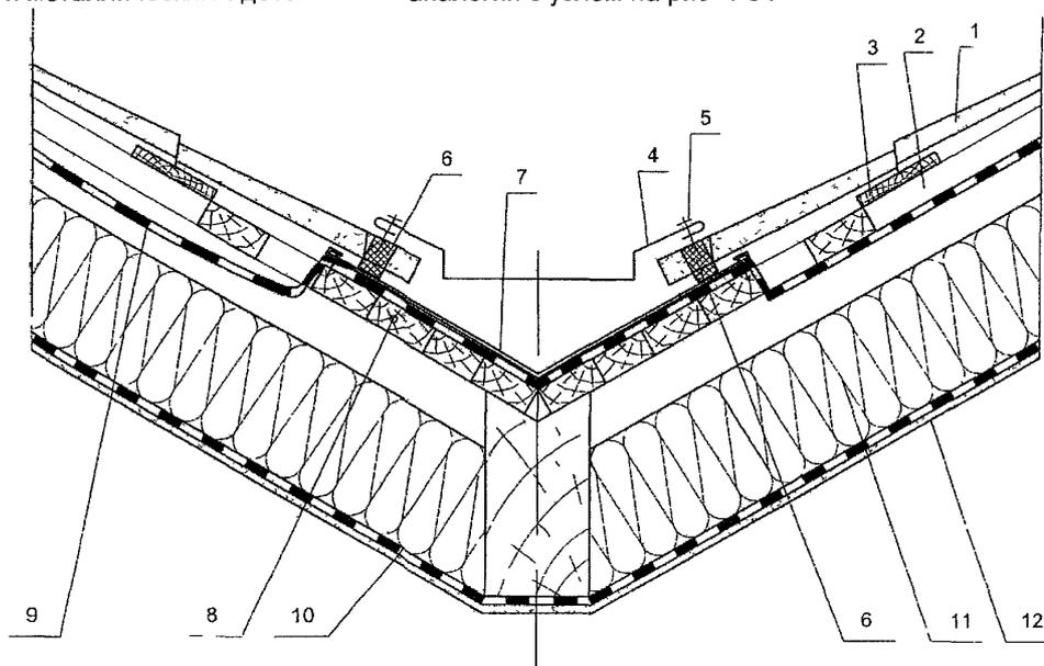
Рис. 1 42. Ендова кровли
