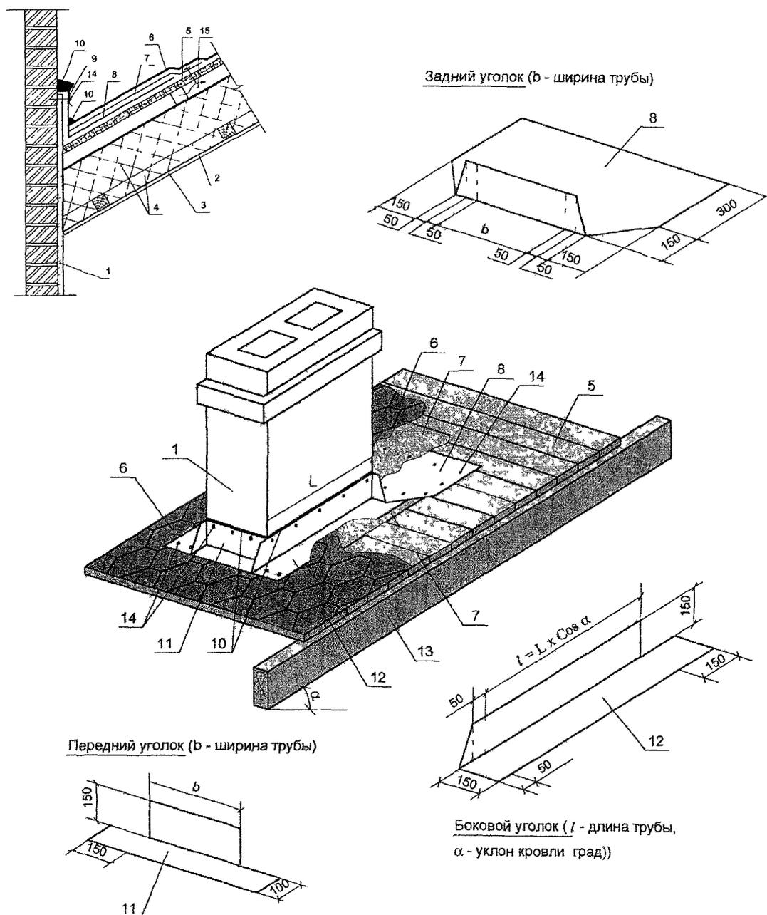
Рис 1 34 Примыкание кровли к кирпичной трубе
