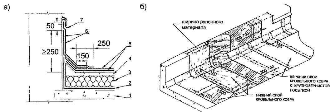
Рис. 2.14 Водоизоляционный ковер на примыкании кровли к стене (а) и раскладка полотнищ рулонного материала (б)
