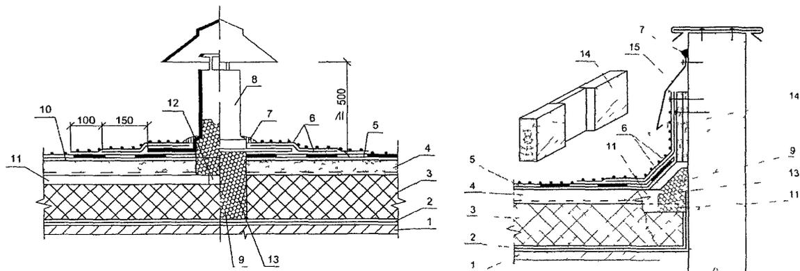
Рис. 2.29 Осушающий патрубок (а) и примыкание каналов к стене с продухом (б)
