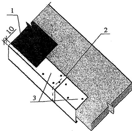
Рис. 2.36. Схема установки карнизной планки
