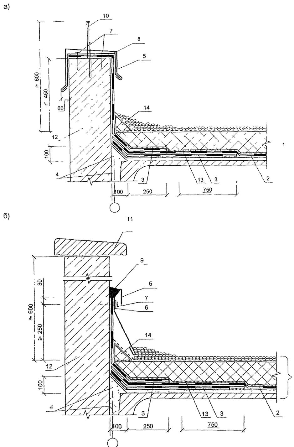
Рис 1 13 Примыкание инверсионной кровли к парапету
