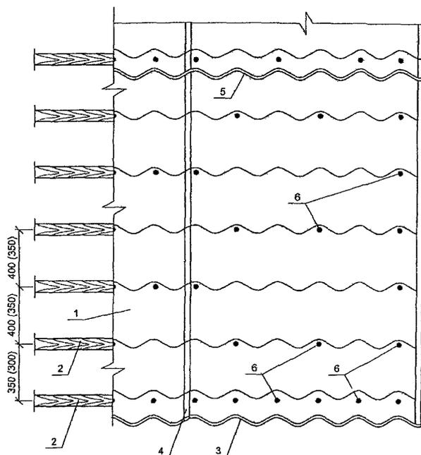
Рис. 2.45. Крепление металлочерепицы
