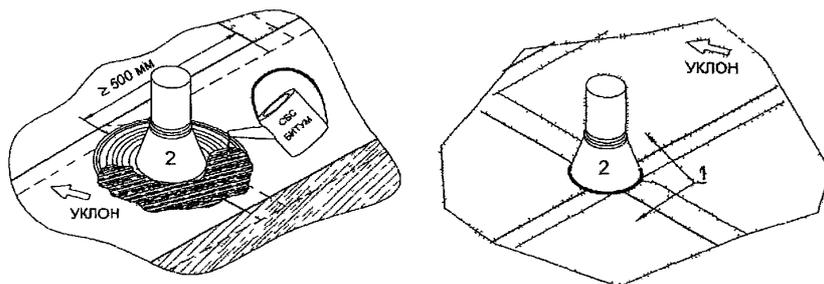
Рис 2 25 Обклейка трубы вторым слоем основного водоизоляционного ковра
