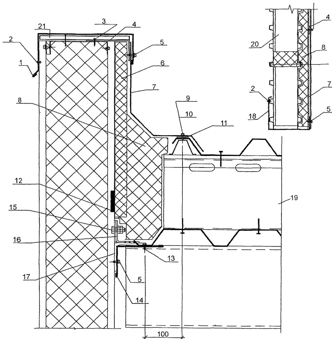
Рис. 1.58. Присоединение профлиста в составе кровельной каркасной панели к стене
