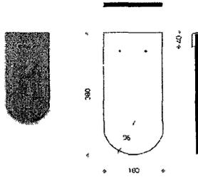
Рис. 1.17. План черепицы, поперечный и продольный разрезы.
