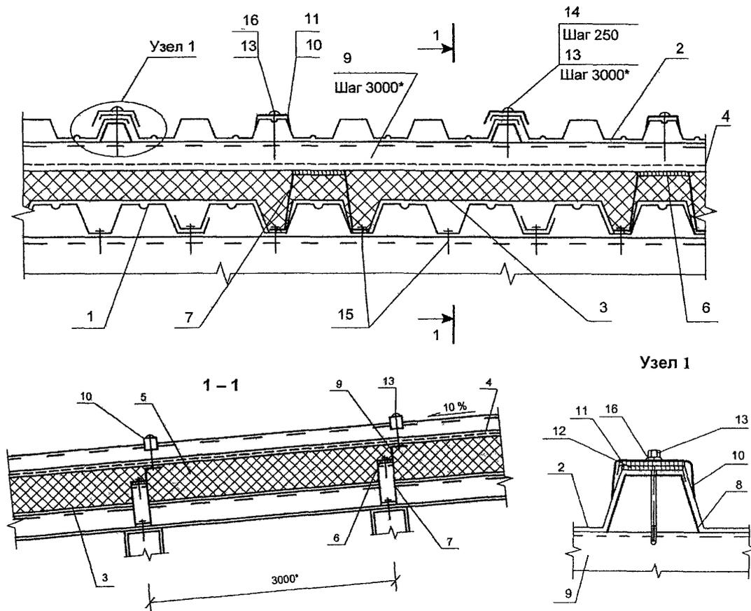
Рис 1.53. Кровля послойной сборки из металлических профилированных листов
