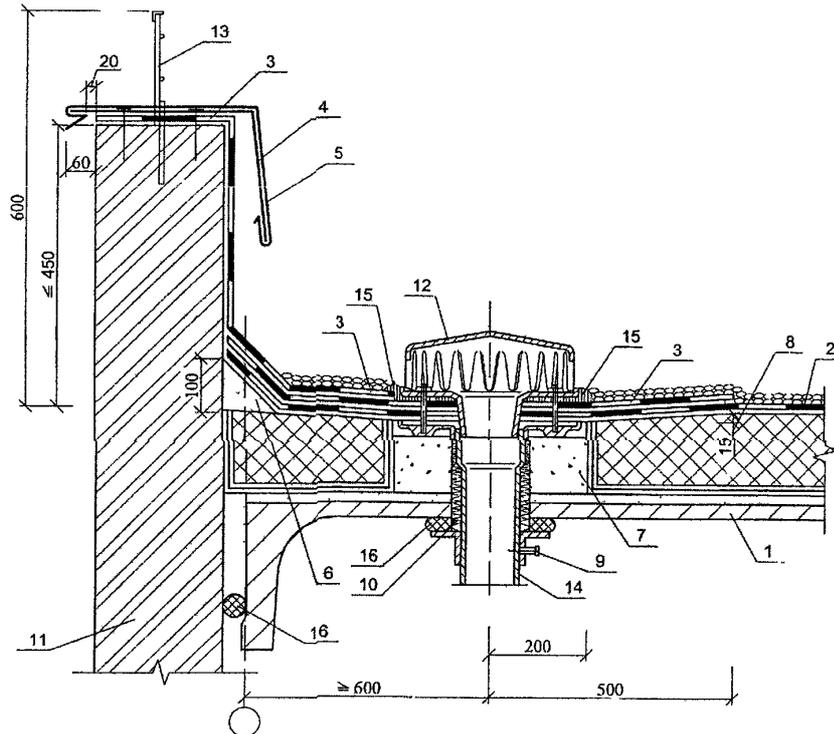
Рис. 1.3. Воронка у примыкания кровли к парапету
