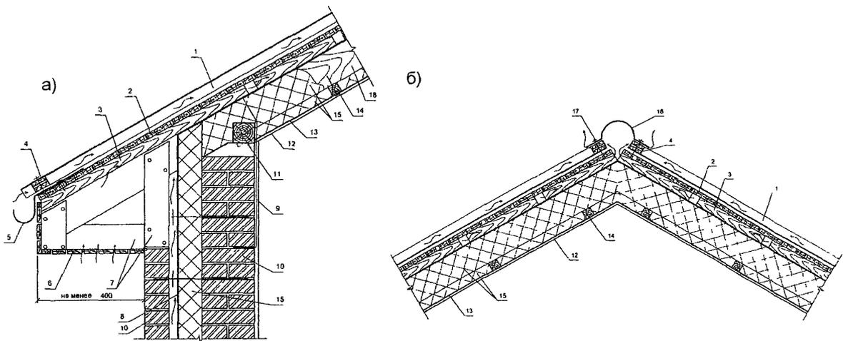
Рис. 1 50 Карнизный (а) и коньковый (б) узлы кровли
