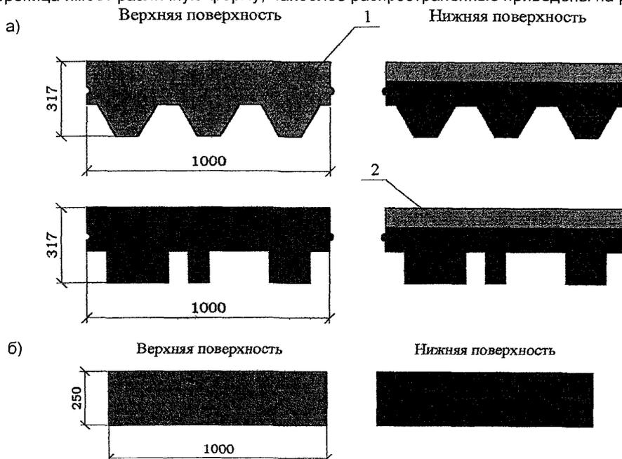
Рис 1 30 Гибкая черепица рядовая (а) и карнизная-коньковая (б)
