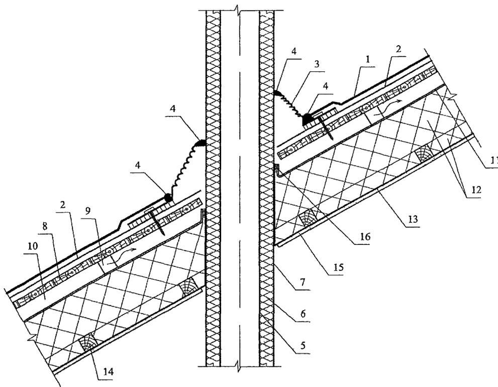
Рис. 1.33. Примыкание кровли к дымовой металлической трубе
