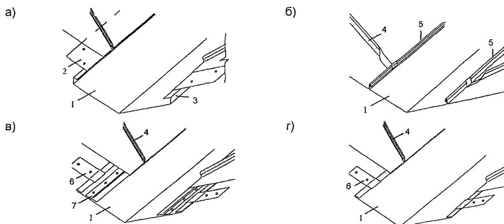
Рис. 1.64. Ендова кровли
