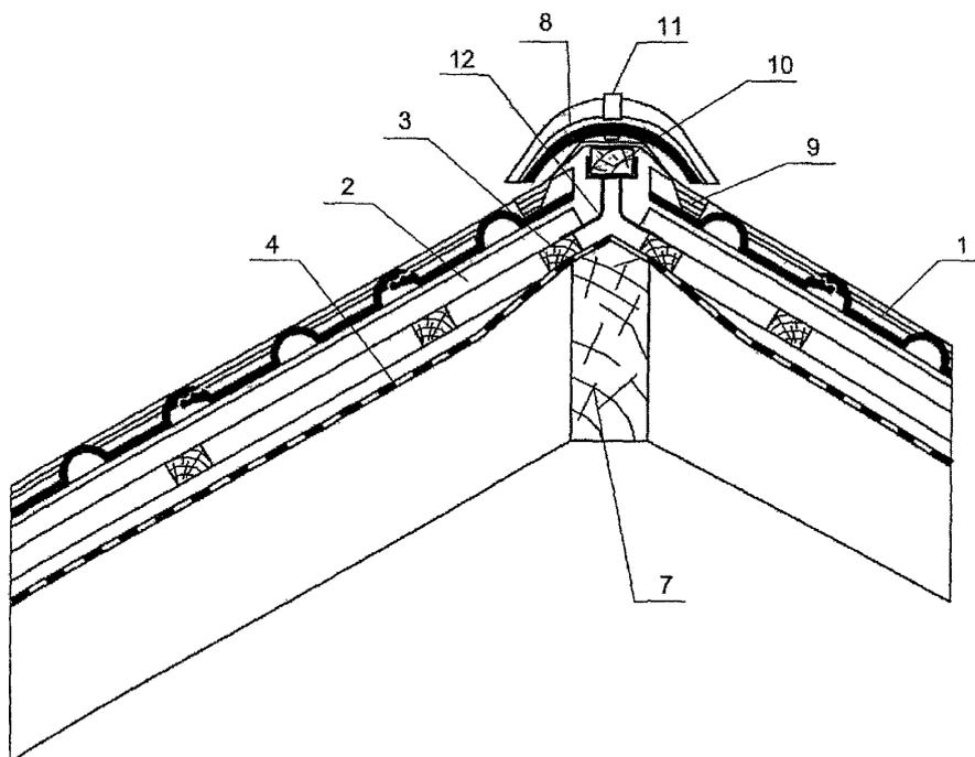
Рис. 1.28. Хребет крыши (а) и чердачной кровли (б)
