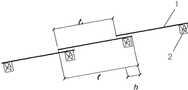
Рис. 3.4. Схема определения ширины нахлестки асбестоцементных листов, металлических профлистов и металлочерепицы
