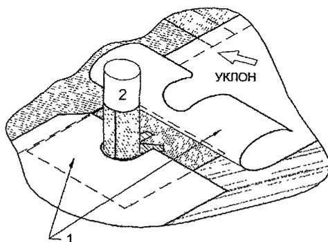
Рис. 2.20. Обклейка трубы нижним слоем основного водоизоляционного ковра
