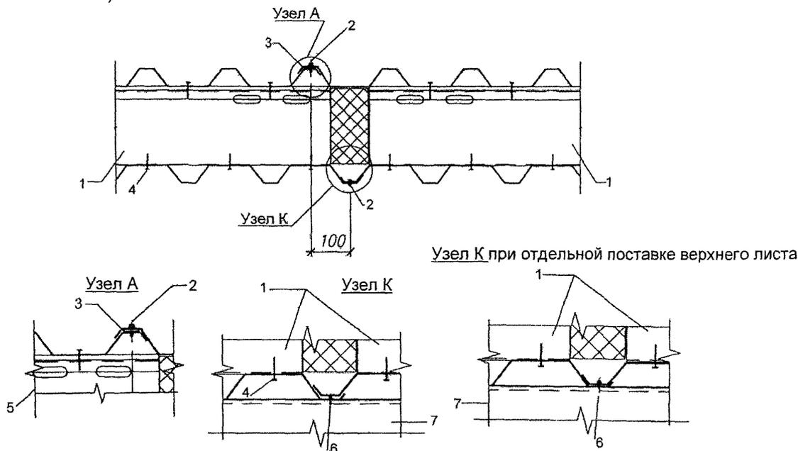
Рис. 2.48. Крепление металлического профлиста в составе кровельной панели
