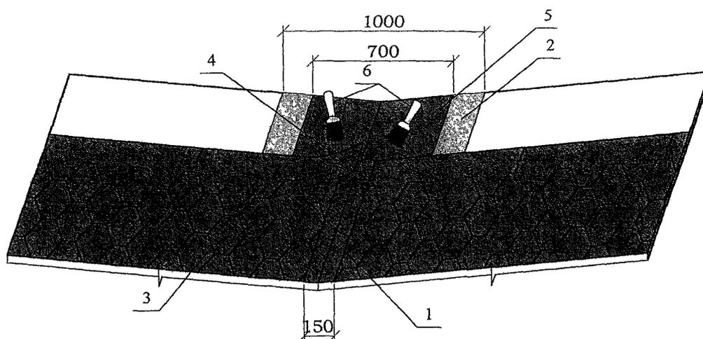
Рис. 2.40. Укладка гибкой черепицы в ендове
