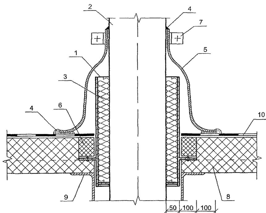
Рис. 1.8 Примыкание кровли к трубе
