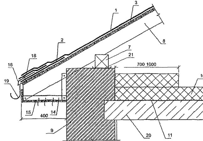
Рис. 1.31. Карнизный узел крыши мансардного этажа (а) и холодного чердака (б)
