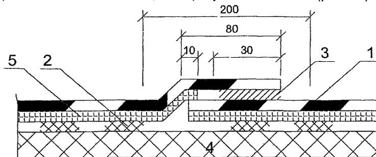
Рис. 2.9. Стык смежных полотнищ термопластичной пленки
