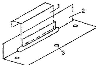
Рис. 1.59 Скользящий кляммер медной кровли
