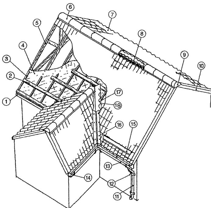
Рис. 1.38. Схема кровли из металлочерепицы
