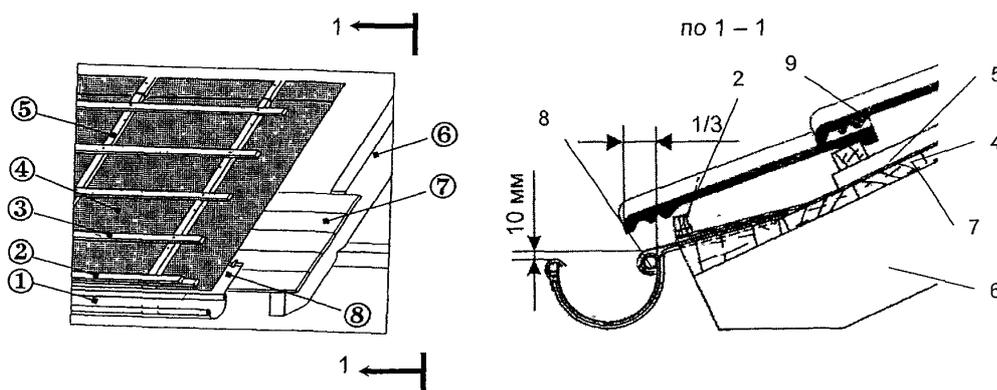
Рис. 2.30. Карнизный свес кровли.
