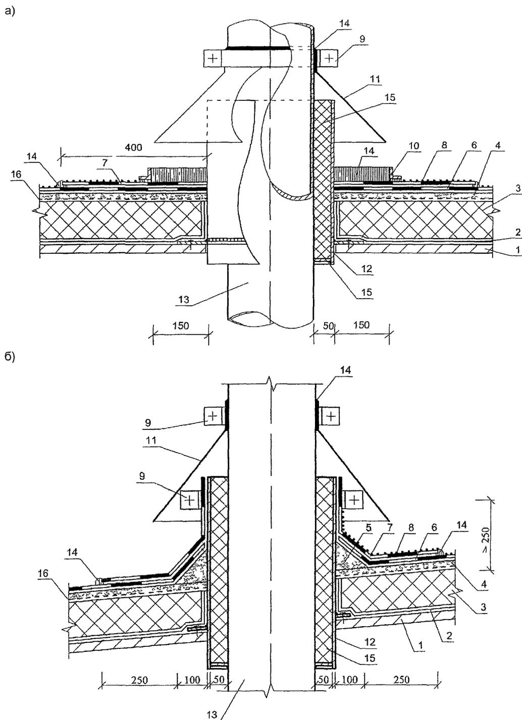
Рис 17 Пропуск трубы через покрытие с традиционной кровлей
