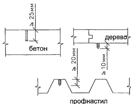
Рис. 2.12. Положение конца крепежного элемента в основании под кровлю (несущем элементе)
