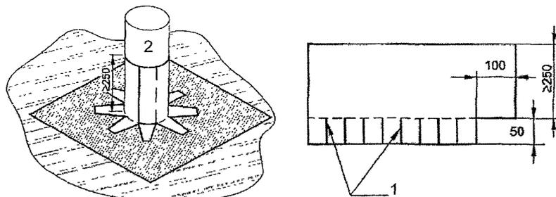
Рис. 2.19. Обклейка трубы нижним слоем дополнительного водоизоляционного ковра
