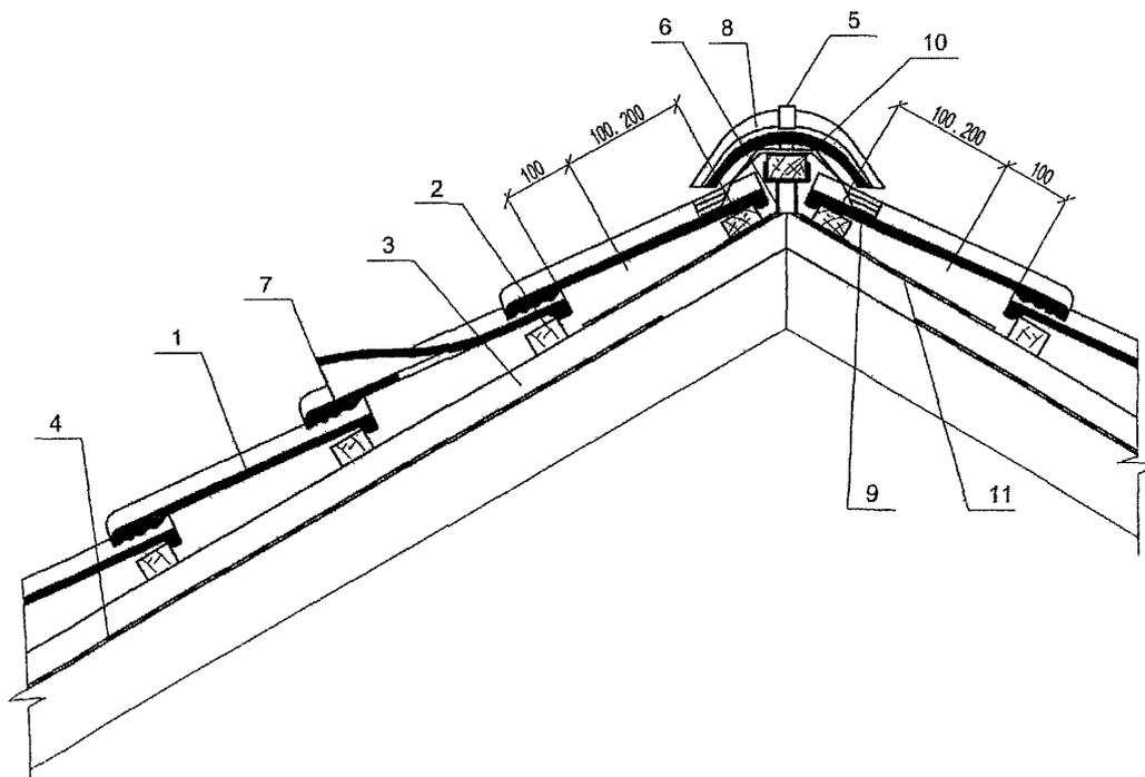
Рис 1.25 Конек чердачной кровли с диффузионно-гидроизоляционной пленкой
