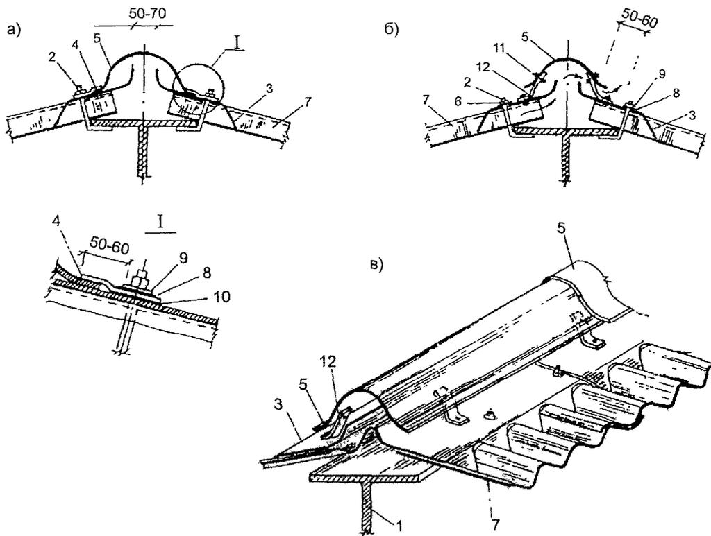
Рис 1 49. Коньковые узлы по металлическим прогонам
