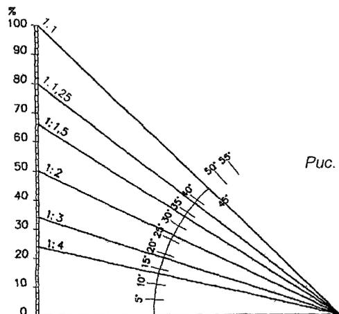
Рис. 3.2. График определения величины уклона в %.
