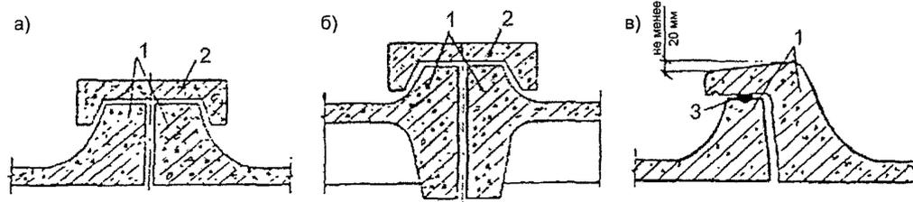
Рис. 1.66. Конструкции стыков кровельных панелей а, б – стык с перекрытием П-образным нащельником; в – стык внахлестку; 1 – кровельная панель; 2 – П-образный нащельник; 3 – герметик (прокладка «вилларем»).
