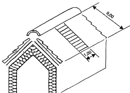
Рис. 1.20 К расчёту вентиляционного зазора на карнизном свесе.
