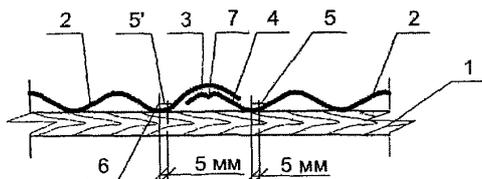
Рис. 2.44. Продольный стык металлочерепицы
