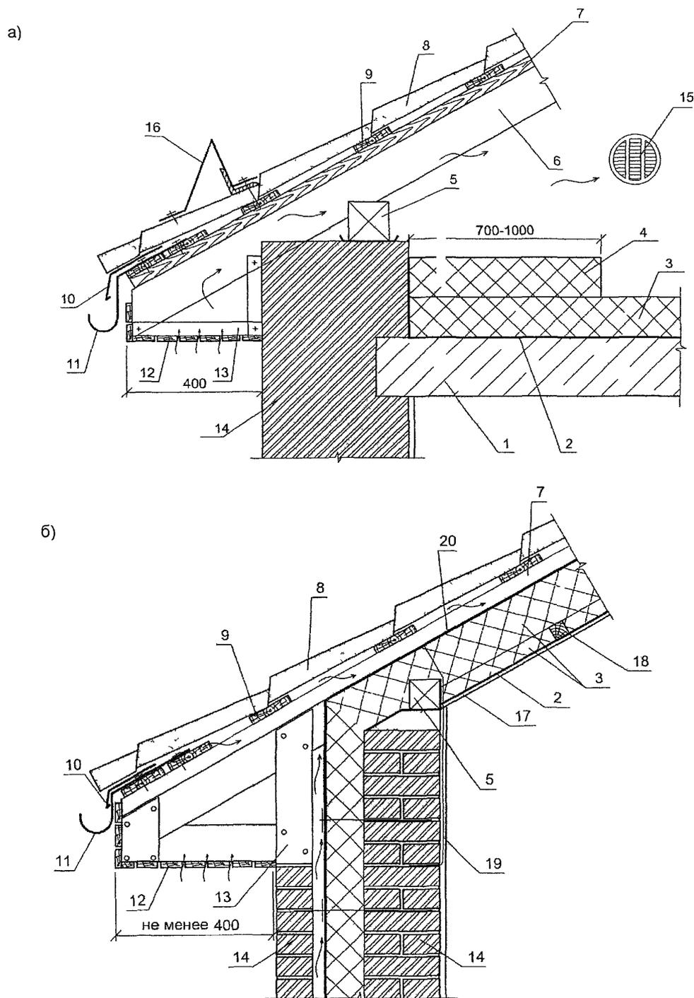
Рис 1 39 Карнизный узел кровли холодного чердака (а) и крыши мансарды (б)
