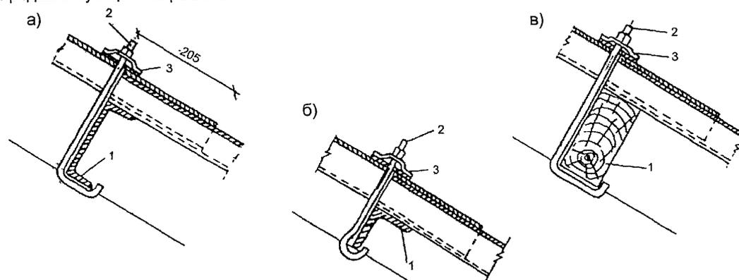
Рис. 2.46. Способы крепления асбестоцементных волнистых листов к прогонам
