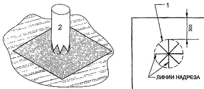
Рис. 2.18. Укладка нижнего слоя дополнительного водоизоляционного ковра
