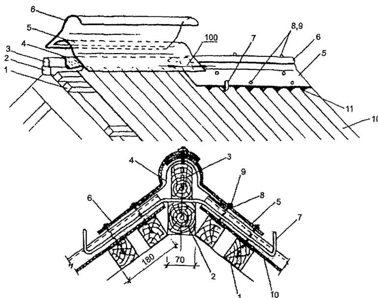
Рис. 1.48. Конек (ребро) кровли по деревянным брускам
