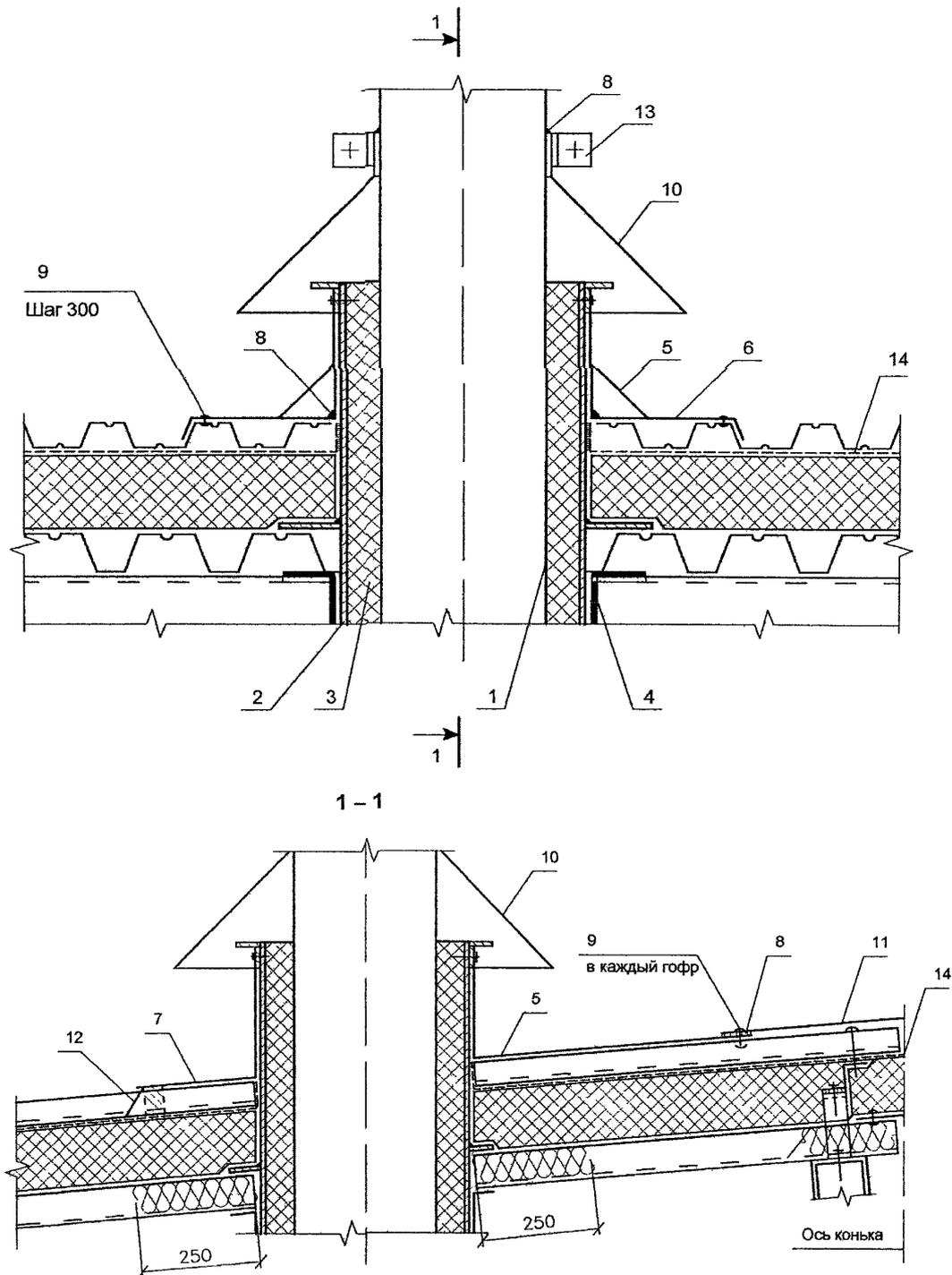
Рис 1 55 Пропуск трубы через кровлю из металлических профилированных листов
