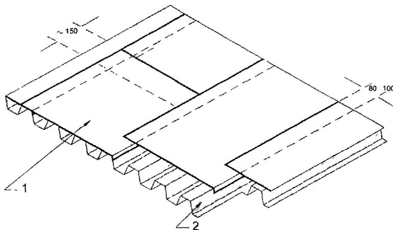
Рис. 2.1. Укладка пароизоляционного материала на профнастил
