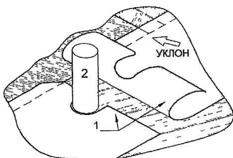
Рис 2 23 Обклейка трубы нижним слоем основного водоизоляционного ковра
