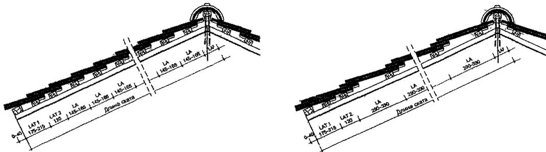
Рис. 1.18. Поперечный разрез кровли (скат кровли) при двойной (а) и при корончатой (б) укладке черепицы.
