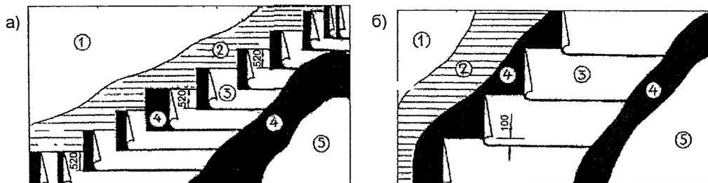
Рис 2 13 Схема расположения слоев мастичного кровельного ковра
