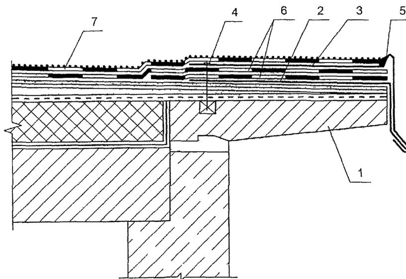
Рис. 1.9 Карниз кровли
