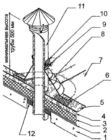
Рис 2 26 Окончательная отделка примыкания кровельного ковра к трубе
