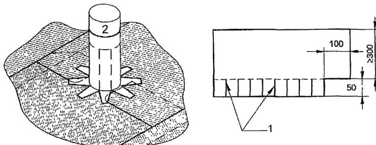
Рис. 2.21. Обклейка трубы верхним слоем дополнительного водоизоляционного ковра
