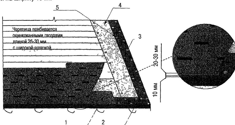
Рис 2 38 Схема укладки гибкой черепицы
