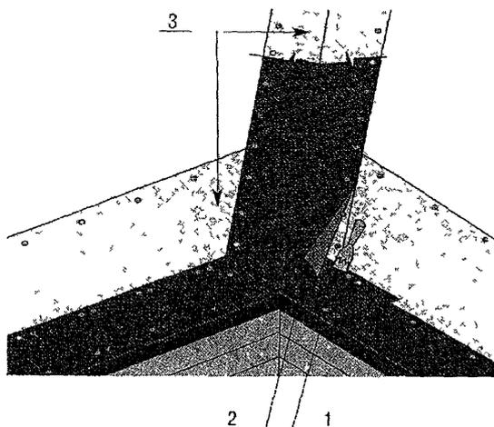
Рис 2 37 Ендова кровли
