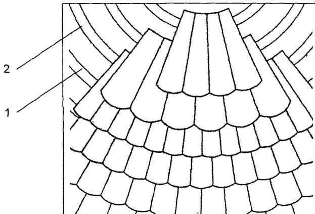
Рис. 2.33. Равномерная укладка черепицы
